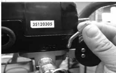
4. Si su compresor está provisto con el kit de purga automática; es conveniente que desenergice el compresor al término de la jornada de trabajo, con el fin de que no se quede el dispositivo de purga automática activado durante periodos de inactividad del equipo.
