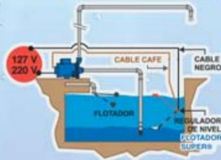
Solo para cisterna utilice las terminales: "Negro y Café"; con estos contactos el flotador enciende hacia arriba y apaga hacia abajo.
