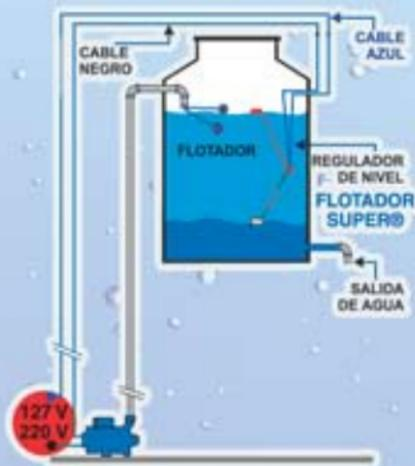
En el tinaco utilice las terminales: "Negro y azul"; con estos contactos el flotador enciende hacia abajo y apaga hacia arriba.
