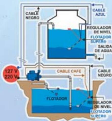
En la cisterna utilice las terminales: "Negro y café"; con estos contactos el flotador enciende hacia arriba y apaga hacia abajo, evitando que la bomba trabaje sin agua.
